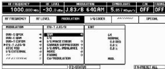
Fig. 5.35 R&S SFQ menu for setting ITU-T J.83/B parameters
